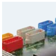
Цветовая кодировка Разработано для быстрого переключения между электросхемами
